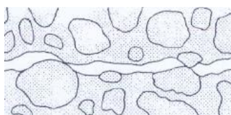
Figura 12 - Atrito entre os agregados (A. Muttoni, Schwartz, Thurlimann, 1997).
